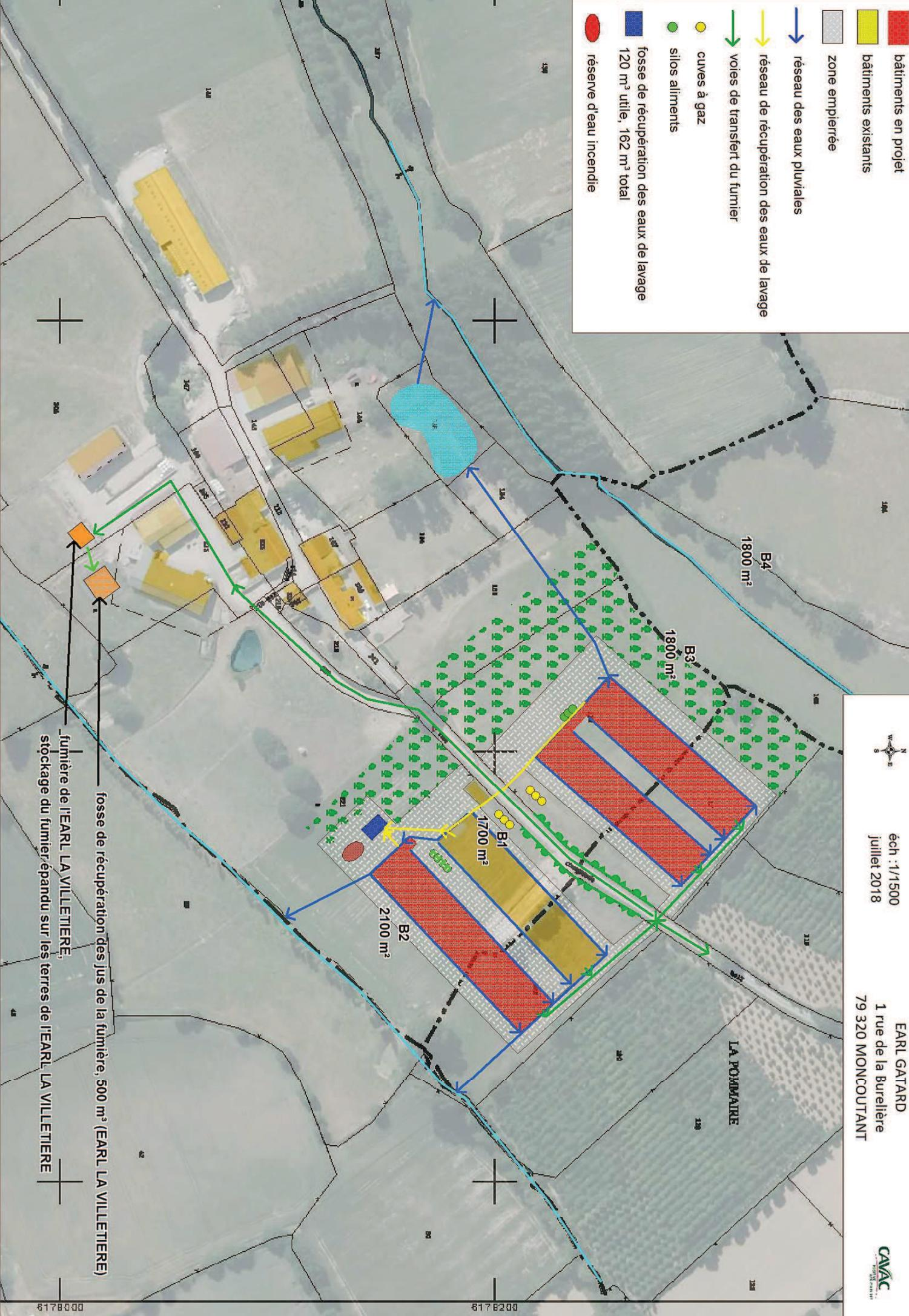
**PLAN DES RÉSEAUX DE GESTION DES EAUX PLUVIALES ET DES EFFLUENTS, SITE "LA VILLETIERE"**
